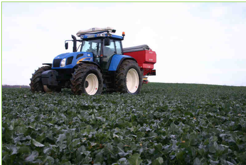
Tracteur avec distributeur centrifuge d'engrais équipé d'un capteur N-Sensor
