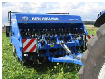
SEMEATO by NEW-HOLLAND PS 2030 (3m – 17 éléments semeurs) Entre rangs : 17.6 cm
