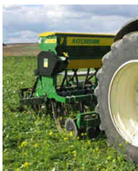
AITCHISON SIM TECH T-Sem (3m – 16 éléments semeurs) Entre rangs : 18.8 cm
