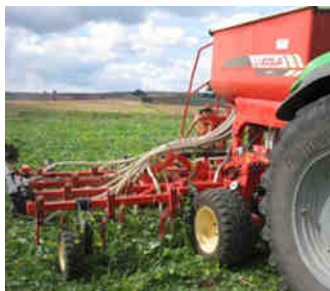
SOLA SM 1909 (6m – 37 éléments semeurs) Entre rangs : 16.2 cm
