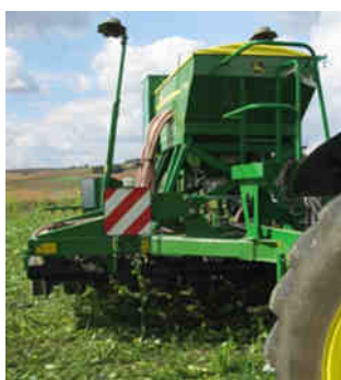
JOHN DEERE 750 A (4m – 24 éléments semeurs) Entre rangs : 16.7 cm
