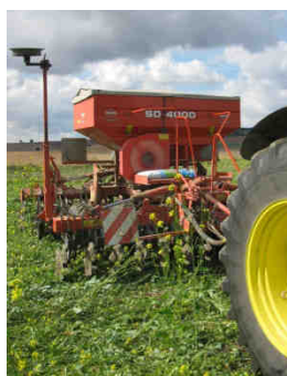
KUHN SD 4000 (4m – 22 éléments semeurs) Entre rangs : 18.2 cm
