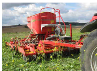
VADERSTAD Rapid A 400S (4m – 32 éléments semeurs) Entre rangs : 12.5 cm
